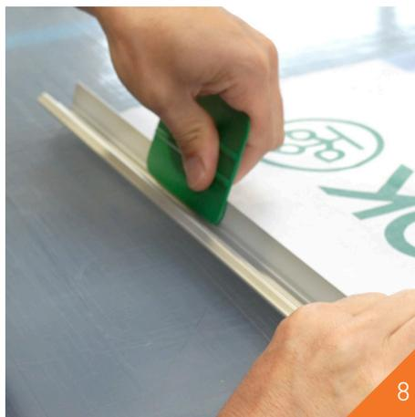
8 Die obere Klemmleiste mit der mitgelieferten Rakel öffnen und das alte Roll-Up entfernen.
